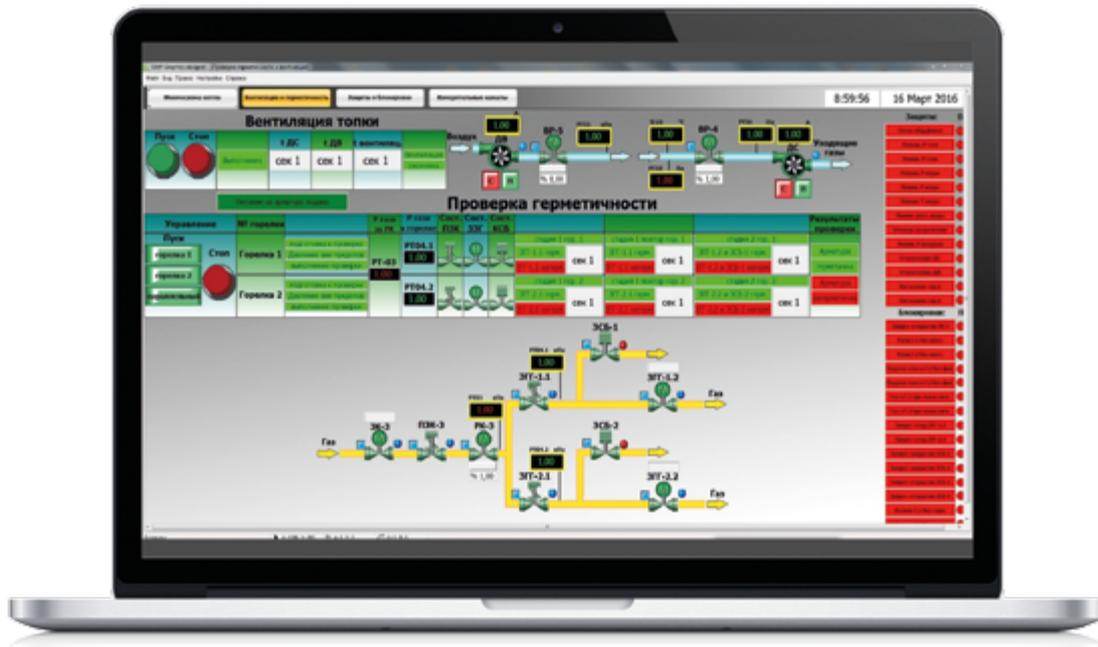
Экран контроля герметичности запорной арматуры (SCADA-система)
